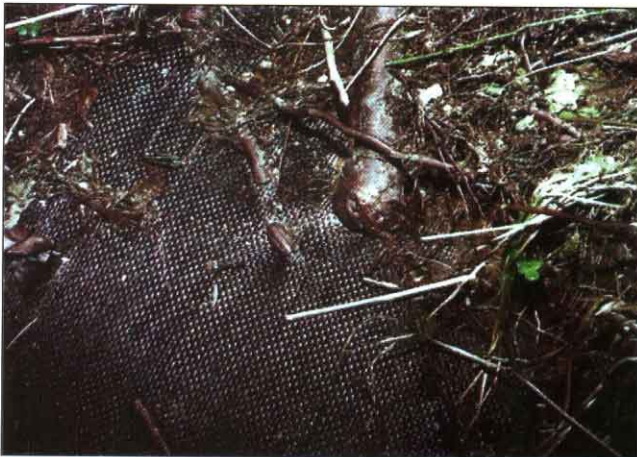
Figure 16. Effet d'étranglement produit sur des racines de saule ayant pénétré dans les mailles fines d'un *géotextile tissé.
