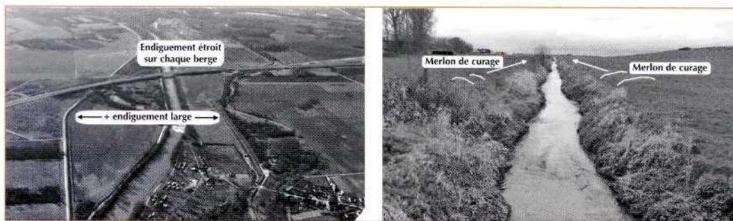
◀ Figure 11 - À gauche: vue aérienne d'un système à double endiguement en zone rurale (protection des cultures) : étroit pour les crues fréquentes et large pour les crues plus rares. À droite : vue de merlons de curage se traduisant par un véritable endiguement.
