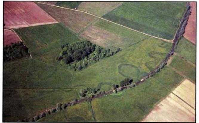
Figure 4. Exemple de rescindement de méandres sur l'Orain (photo Luc TERRAZ, DIREN Franche-Comté)
