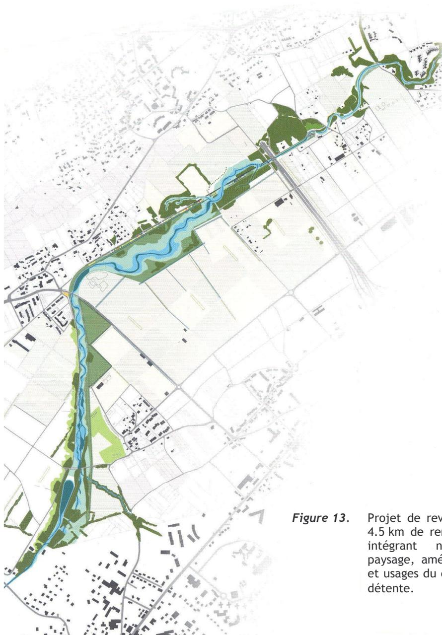
*Figure 13.* Projet de revitalisation de l'Aire : 4.5 km de renaturation de rivière intégrant nature, agriculture, paysage, aménagement, fonctions et usages du cours d'eau, loisirs et détente.
