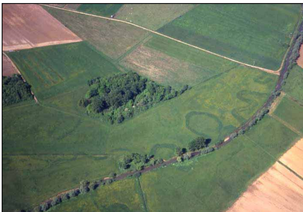
Figure 7. Exemple de rescindement de méandres sur l'Orain (photo Luc Terraz).
