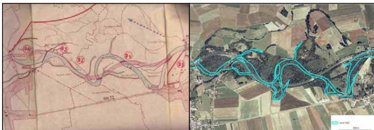
Figure 8. Exemple d'avant projet de rescindement de méandres sur la Loue et tracé actuel. (Source : DDE 39 et IGN in Malavoi, 2006).
